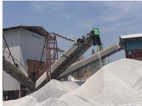
รูปที่ 2-11: การปิดคลุมสายพานลำเลียง
